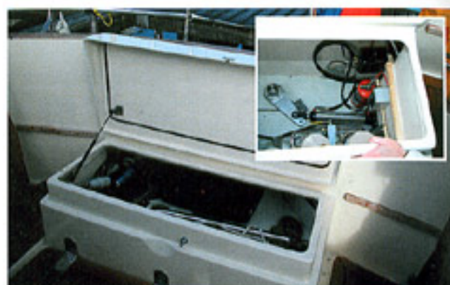
In de ene bakskist zitten oploerbare davits, in de andere kan worden overgeschakeld naar een andere filter of wlerpot.
